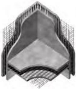
El espacio se completa con una placa aislante acorde con las necesidades del proyecto. En esta vivienda los aislamientos son de **14 cm de EPS en paredes exteriores, 8 cm de EPS** en interiores (de ser necesarias) y **20 cm de EPS en medio del forjado**, sin puentes térmicos.
